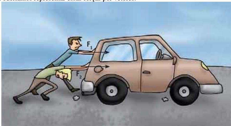
Admitindo que  $F_1$  tenha intensidade de 28N e a  $F_2$  seja de 32N, para substituí-las com o mesmo efeito, determine a intensidade da força resultante.
