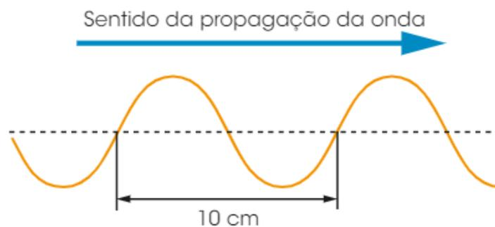
Sabe-se que sua velocidade de propagação é igual a 20 cm/s. Sabendo que a frequência de uma onda depende apenas de sua fonte, determine a frequência da fonte dessa onda em hertz.
