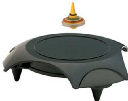
Esse pião, que fica girando em pleno ar por alguns minutos, nada mais é do que um ímã em forma de disco atravessado por um eixo de plástico. Esse eixo é necessário para que o geek inicie a rotação do pião. A base, que também é constituída de um ímã em forma de placa, apoia-se em superfície, necessariamente, horizontal. Indique no desenho representativo do gadget, um possível esquema de polaridades para os ímãs que constituem o pião e a base.
