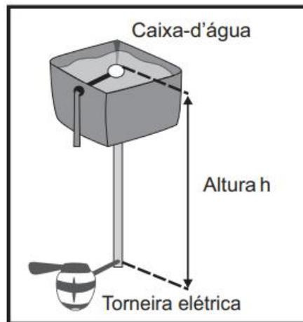
Para que a torneira funcione corretamente, sem o uso do redutor de pressão, quais deverão ser a mínima e a máxima altura entre a torneira e a caixa d'água?
